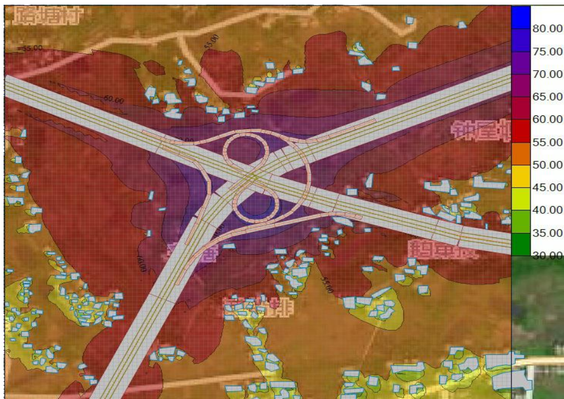
图 4.4-7b 无措施时创业路-客家大道立交贡献值等声级线图（远期夜间）
